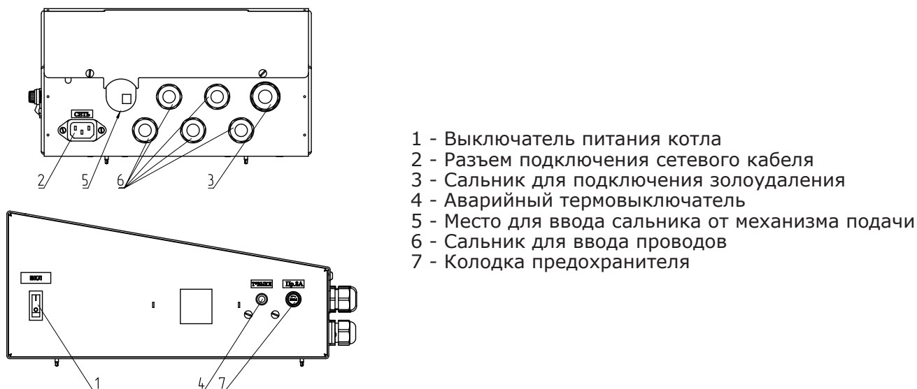
Рис.7 Расположение разъемов подключения на задней и боковой панелях пульта управления.
